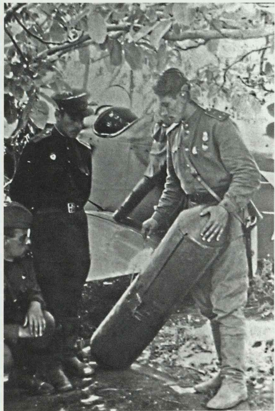
— ★ — Василий Дмитриевич Рыжов, житель г. Рязани, в годы войны – командир АЭ, капитан, старший инженер и техник-лейтенант В.П. Ваняев принимают экзамен по устройству и эксплуатации подвесных кассет для мелких бомб и ампул АЖ-2КС у командира звена лейтенанта Д.П. Пузина на стоянке самолетов
